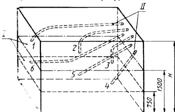
— уровни отбора проб воздуха (750; 1500 мм); II — трубы для отбора проб воздуха из камеры; 1; 2; 3; 4; 5; 6 — точки отбора проб воздуха
