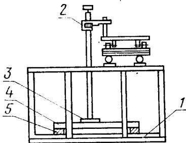
1 — плита; 2 — измеритель высоты (глубиномер); 3 — площадка для измерения высоты мягкого элемента диаметром 80 мм; 4 — испытываемый образец; 5 — брусков, применяемый при испытании образцов с гибким, комбинированным и эластичным основаниями
