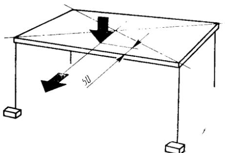
Увеличивают горизонтальную силу до тех пор, пока хотя бы одна из ножек с противоположной стороны стола не оторвется от пола.
